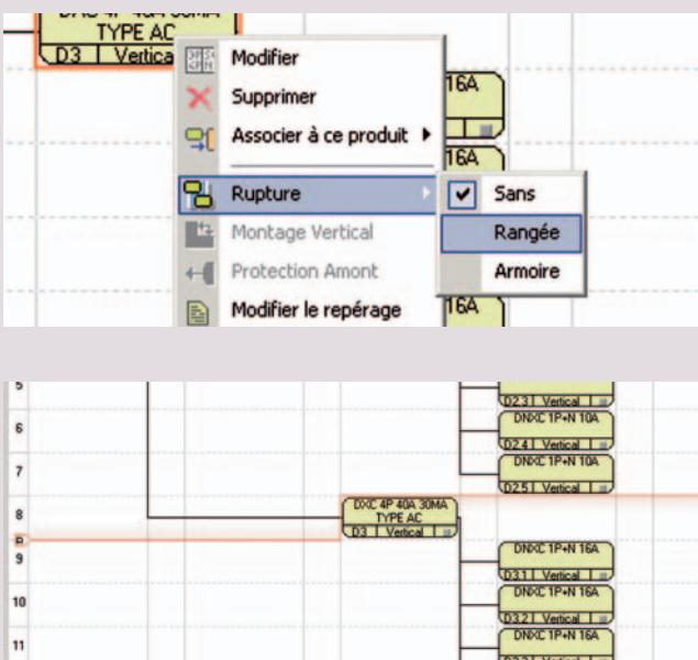
Les ruptures ne sont vraiment matérialisées que dans le module **Visualisation** (voir page 50). Elles ont toutefois une incidence sur la détermination de l'enveloppe.
