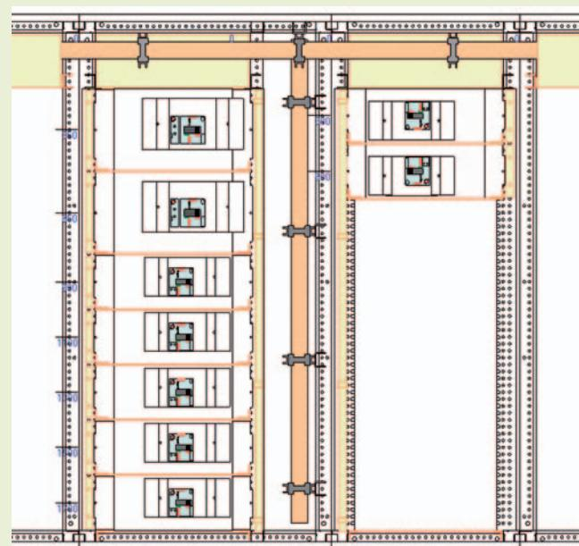
XL-Pro<sup>2</sup> crée automatiquement les jeux de barres dérivés ainsi que les gaines à câbles permettant leur montage et leur raccordement.
