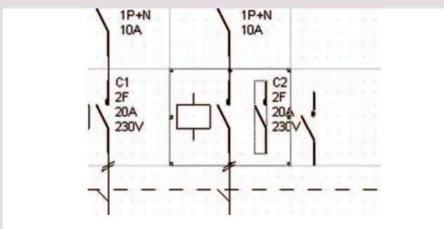
Déplacer le deuxième symbole de contact sur le circuit d'éclairage situé à gauche sur le schéma. Pour l'insérer dans le circuit, cliquer sur **Gestion > Puissance** dans le menu contextuel.
