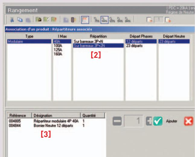
Le retour au module **Rangement** permet de voir que les produits de répartition ont été ajoutés dans les colonnes 1 bis et 3 bis. Ils sont connectés directement à la sortie de l'appareil auquel ils sont associés et alimentent les appareils aval.
