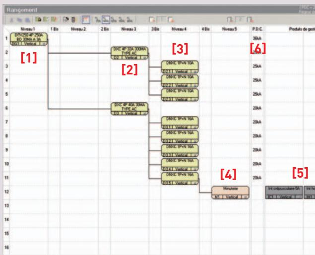
En dehors des inverseurs de sources (voir page 78), aucun appareil n'est placé au niveau 2.
