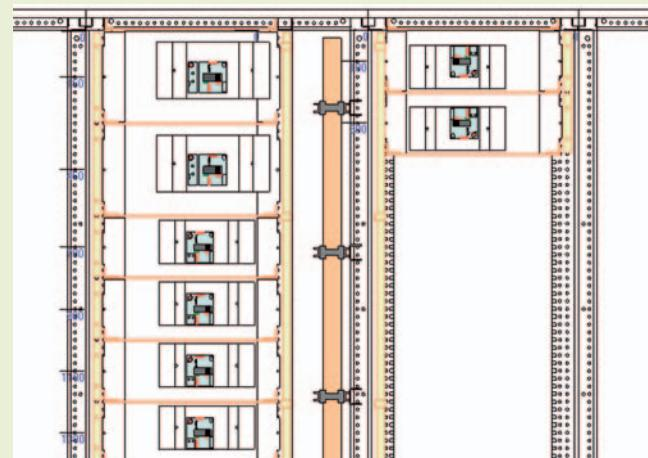
Dans l'exemple ci-dessus, le jeu de barres horizontal haut a finalement été supprimé car il n'était pas nécessaire de le conserver.
