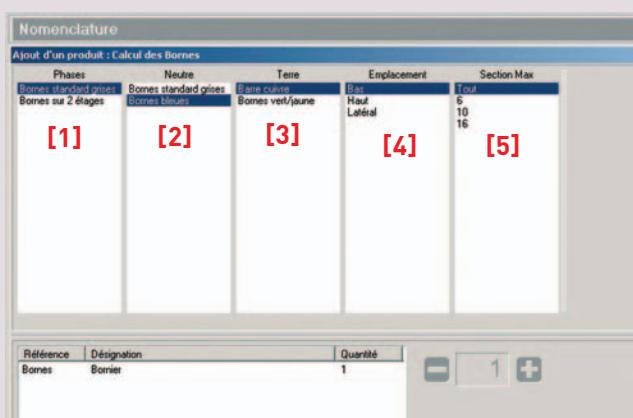
XL PRO<sup>2</sup> ne prévoira pas de bornes pour les sections supérieures à la section choisie, considérant que ces sorties seront directement raccordées sur l'appareil.
