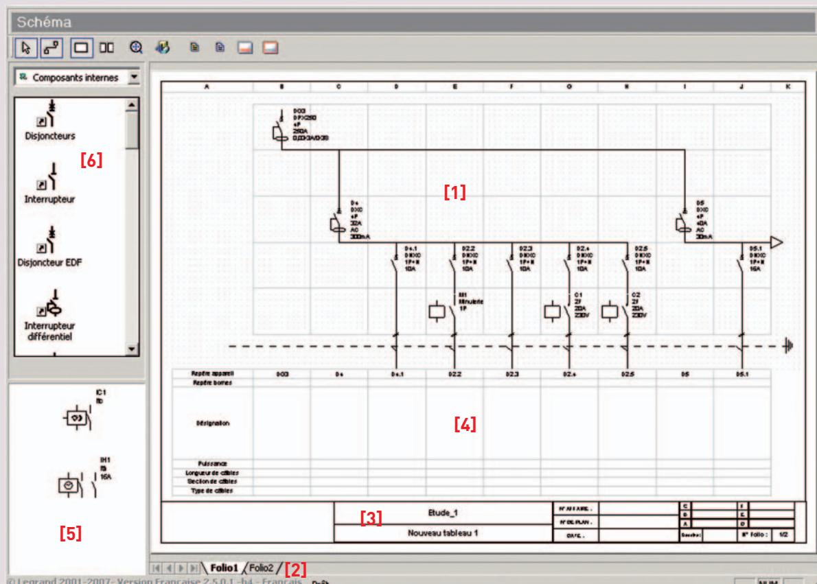
Le schéma est lié directement à l’arborescence du module **Rangement**. Les produits occupent chacun une case sur une grille au pas de 25 mm [1] (grille Puissance). Leur entrée est raccordée à la sortie du premier appareil de niveau supérieur situé à leur gauche. XL PRO<sup>2</sup> répartit le schéma sur autant de folios qu’il est nécessaire. Numérotés en séquence, ils sont accessibles par les onglets situés en-dessous du schéma [2].
