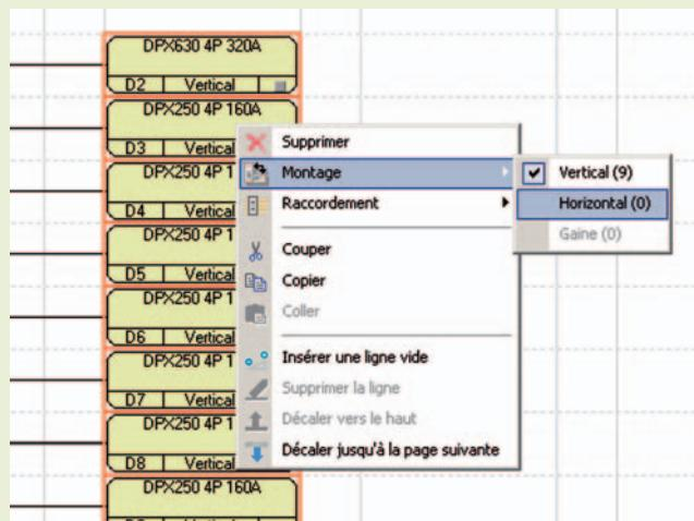
Si les DPX ne sont pas positionnés horizontalement, XL-Pro<sup>2</sup> le fera automatiquement lors du choix de la forme, sauf pour les inverseurs de sources.
