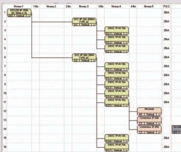
Seuls la minuterie, les contacteurs et les derniers disjoncteurs ajoutés ne sont à leur place dans l'arborescence. Les 2 disjoncteurs 10 A se sont placés sur les deux dernières lignes.
