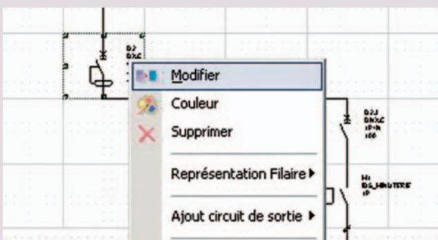
La fenêtre de choix des caractéristiques apparaît (voir page 13). La colonne **Type de Circuit** présente les cas les plus fréquents d'utilisation d'un disjoncteur divisionnaire. Choisir **1 Circuit + 1 départ éclairage de sécurité** puis valider. La modification apparaît immédiatement sur le schéma.
