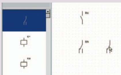
Lorsque les symboles sont posés sur le schéma, un marquage automatique permet de savoir à quel appareil ils appartiennent. Les composants provenant d'un appareil de puissance sont accompagnés du repère de cet appareil.
